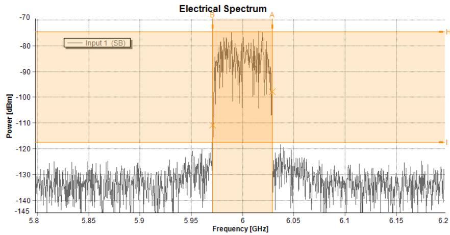
Figura 6.8: PM-IM: Componente fundamental do sinal RF de *uplink* recebida para potência RF de entrada *nodownlink* de -6 dBm e -6 dBm de *uplink*; Nível de Potência RF à saída: -74 dBm ;Nível de Ruído: -114; SNR: 40 dB ; EVM: 0,8 %
