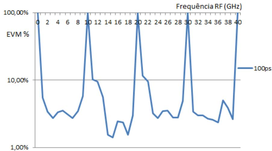
Figura 5.32: PM-BD: EVM para frequências RF em intervalos de 40 GHz para valores no interferômetro de 100 ps
