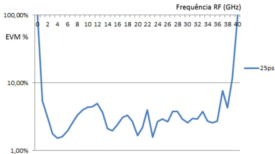
Figura 5.31: PM-BD: EVM para frequências RF em intervalos de 40 GHz para valores no interferómetro de 25 ps
