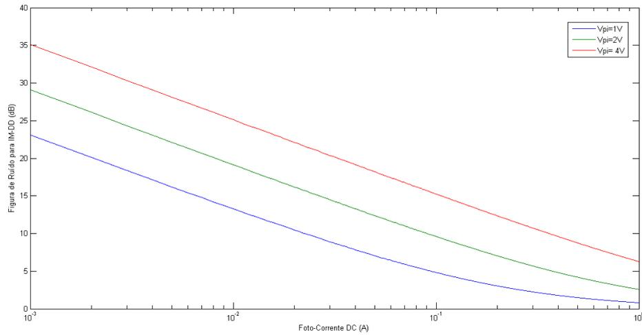
Figura 4.4: Figura de ruído da configuração IMDD em relação com a foto-corrente para diferentes valores de  $V_{\pi}$
