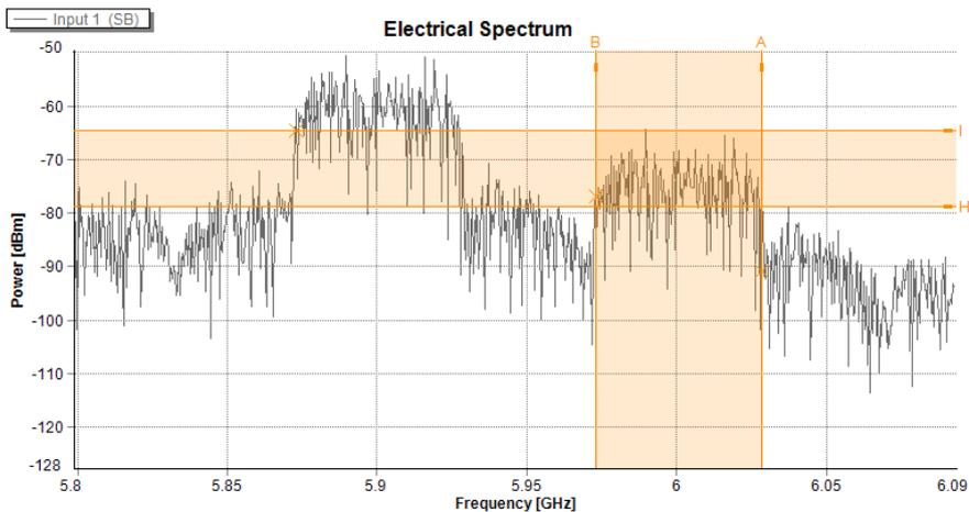
Figura 6.14: IM-IM: Componente fundamental do sinal RF de *uplink* recebida para potência RF de entrada no *downlink* de 6 dBm e -6 dBm de *uplink*; Nível de Potência RF à saída: -64 dBm ; Nível de Ruído: -78 dBm ; SNR: 14 dB EVM: 25,3 %
