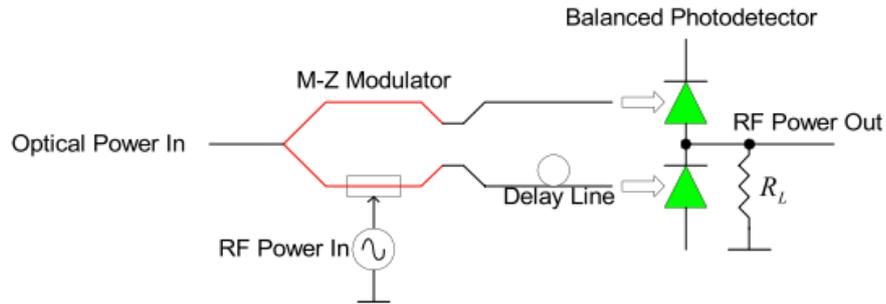
Figura 3.7: Deteção Balanceada
