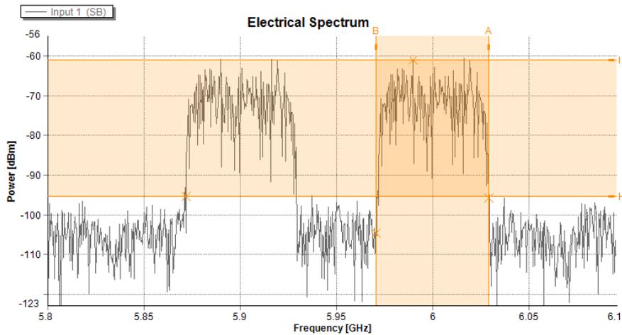
Figura 6.13: PM-BD: Espectro elétrico recebido no detetor de *uplink* para potência RF de entrada no *downlink* e *uplink* de -6 dBm; Nível de potência RF à saída: -60 dBm ;Nível de Ruído: -95 dBm; SNR: 35 dB EVM: 1,45 %
