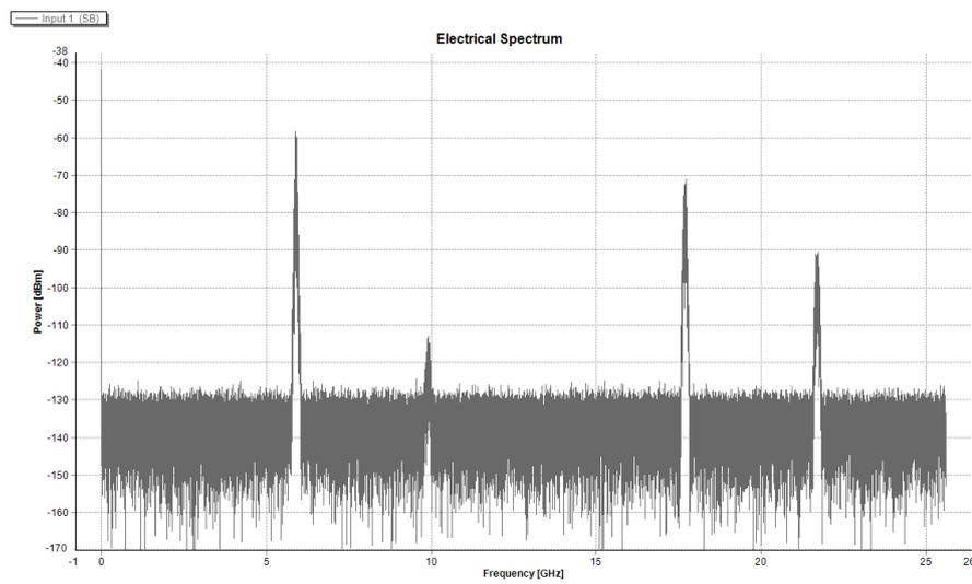
Figura 5.20: IM-DD: Espectro elétrico para ligação com nível de potência RF de entrada de 16 dBm
