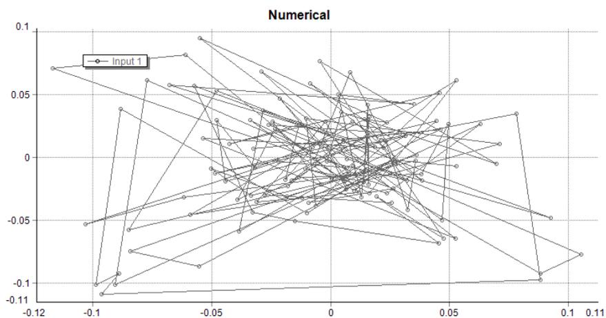
Figura 5.25: IM-DD: Constelação para EVM máximo de 100% para nível de potência de 16 dBm
