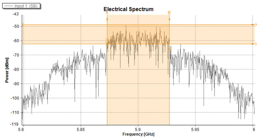
Figura 5.16: PM-BD: Espectro aproximado da componente fundamental com frequência central a 5.9 GHz. Nível de potência RF: 10 dBm, Nível de potência recebida: -48 dBm, Nível de ruído: -61 dBm, SNR: EVM: 28 %
