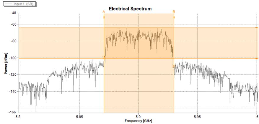
Figura 5.6: IM-DD: Espectro aproximado da componente fundamental com frequência central a 5.9 GHz. Nível de potência RF: -2 dBm, Nível de potência recebida: -64 dBm , Nível de ruído: -101 dBm, SNR: 37 dB EVM: 1,98 %
