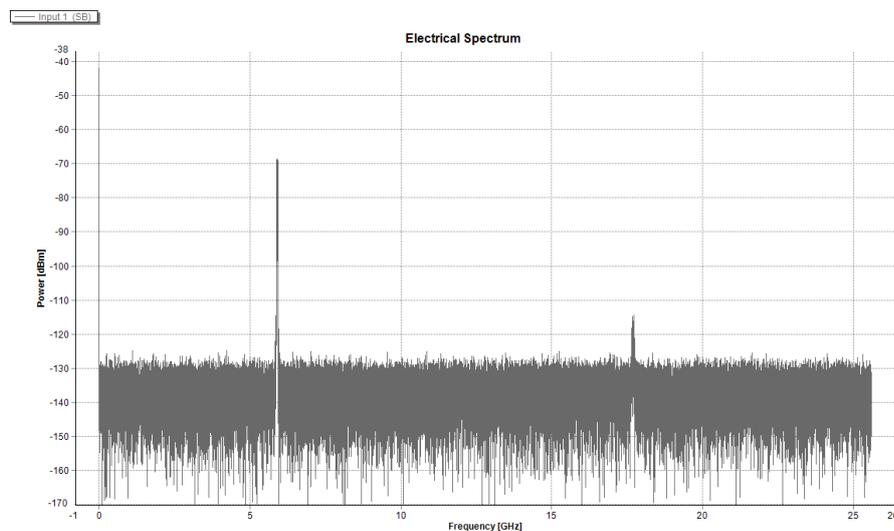
Figura 5.18: IM-DD: Espectro elétrico para ligação com nível de potência RF de entrada de -6 dBm
