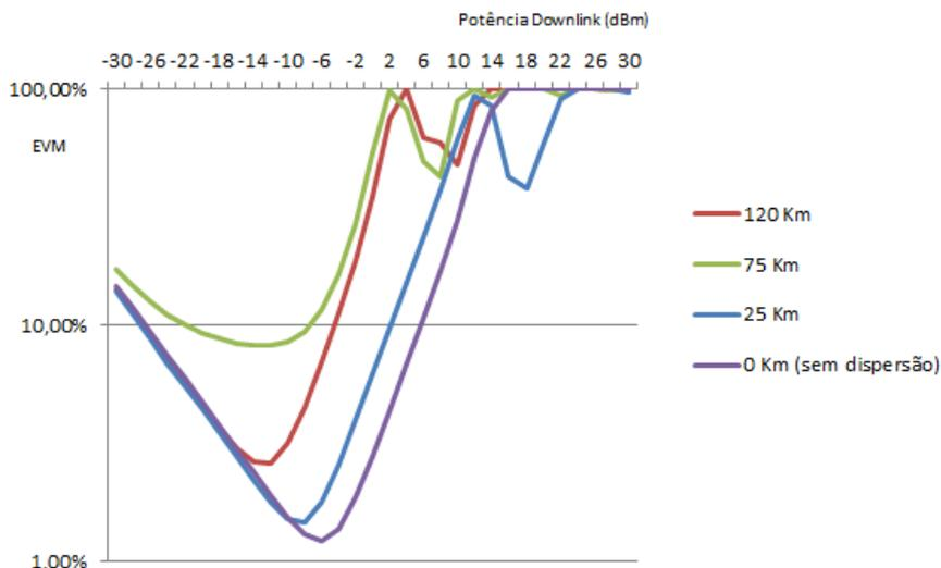
Figura 5.30: Evolução do EVM com a potência de entrada de *downlink* para comprimentos de fibra de 0, 25, 75 e 120 Km
