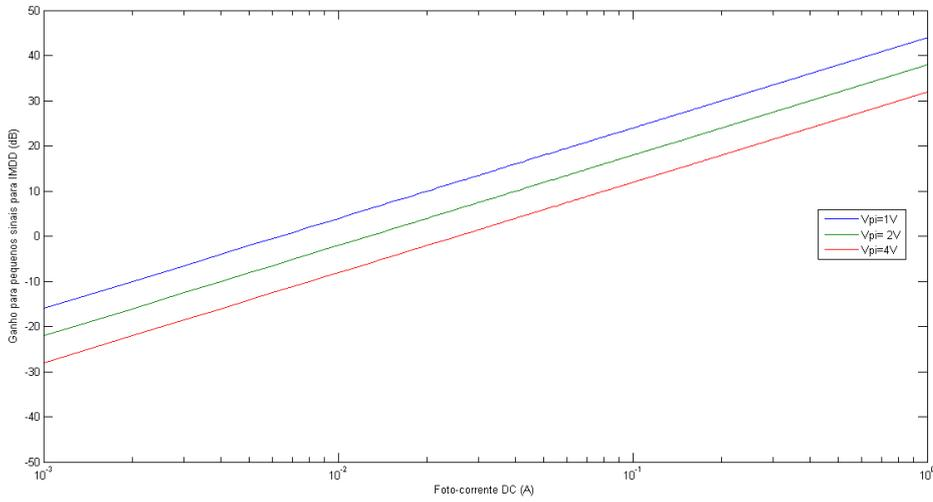
Figura 4.3: Ganho da configuração IMDD em relação com a foto-corrente para diferentes valores de  $V_\pi$
