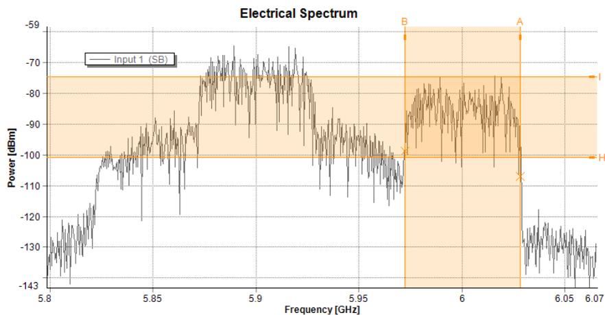
Figura 6.4: IM-IM: Componente fundamental do sinal RF de *uplink* recebida para potência RF de entrada no *downlink* de 6 dBm e -6 dBm de *uplink*; Nível de Potência RF à saída: -74 dBm ; Nível de Ruído: -100 dBm ; SNR: 26 dB; EVM: 1,8%
