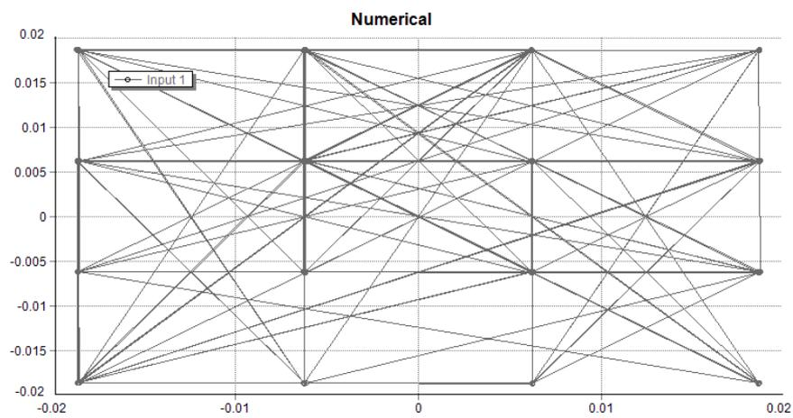
Figura 5.24: IM-DD: Constelação para EVM mínimo de 0,31 % para nível de potência -12 dBm
