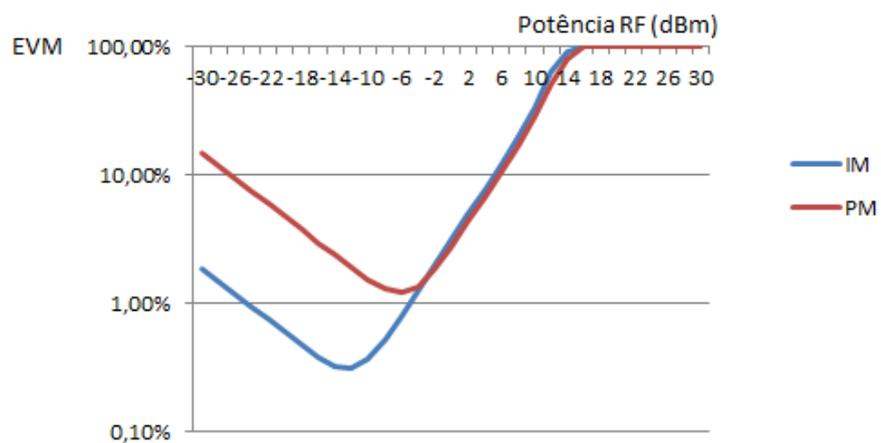
Figura 5.3: Relação entre EVM nas duas configurações vs Potência de sinal de entrada RF
