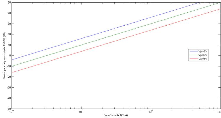
Figura 4.6: Ganho da configuração PMBD em relação à corrente foto-detetada para diferentes valores de  $V_\pi$
