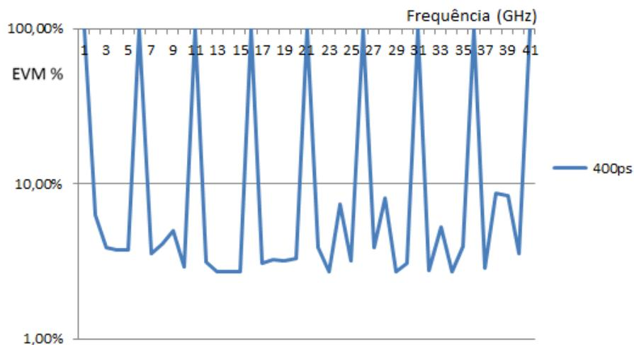
Figura 5.33: PM:BD EVM para frequências RF em intervalos de 40 GB para valores no interferômetro de 400 ps
