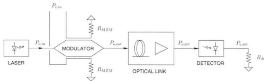
Figura 4.1: Modulação em intensidade (*Mach-Zehnder* com detecção direta [4])
