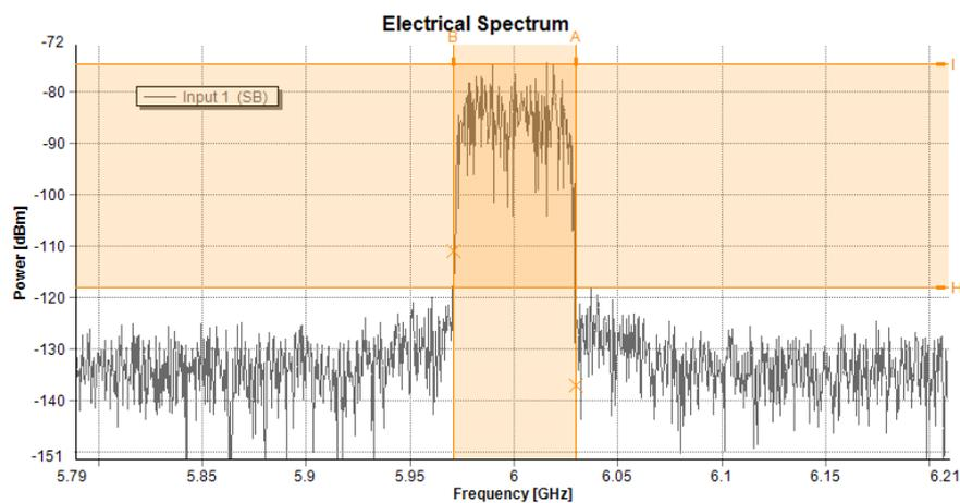
Figura 6.9: PM-IM: Componente fundamental do sinal RF de *uplink* recebida para potência RF de entrada *nodownlink* de 6 dBm e -6 dBm de *uplink*; Nível de Potência RF à saída: -74 dBm ;Nível de Ruído: -114; SNR: 40 dB; EVM: 0,8 %
