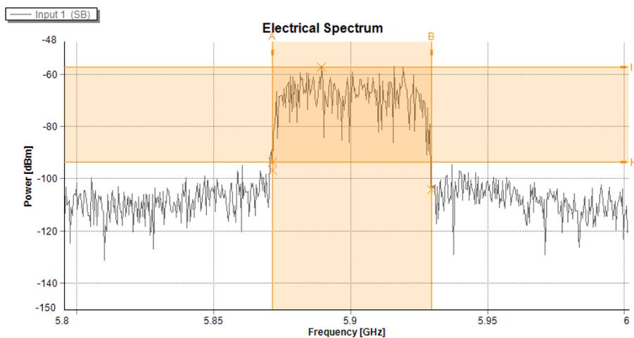
Figura 5.13: PM-BD: Espectro aproximado da componente fundamental com frequência central a 5.9 Ghz. Nível de potência RF: -2 dBm, Nível de potência recebida: -57 dBm, Nível de ruído: -93, SNR: 36 dB EVM: 1,86 %
