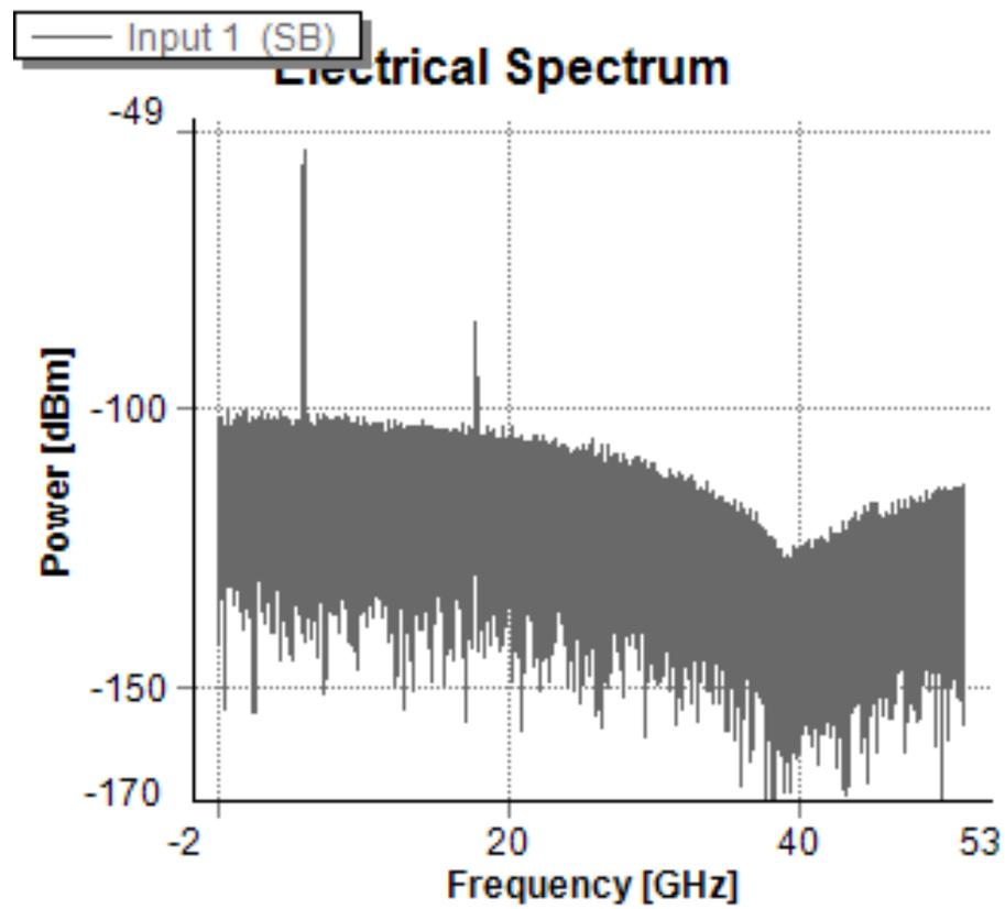
Figura 5.22: PM-BD: Espectro elétrico para ligação com nível de potência RF de entrada de 2 dBm
