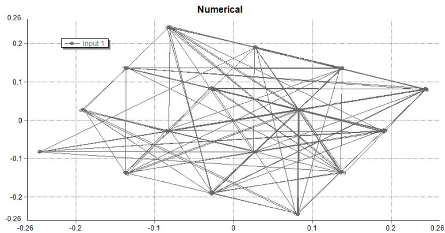
Figura 5.26: PM-BD: Constelação para EVM mínimo de 1,21% para nível de potência de -6 dBm
