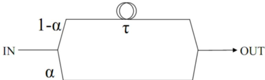
Figura 3.6: Interferómetro com atraso [5]
