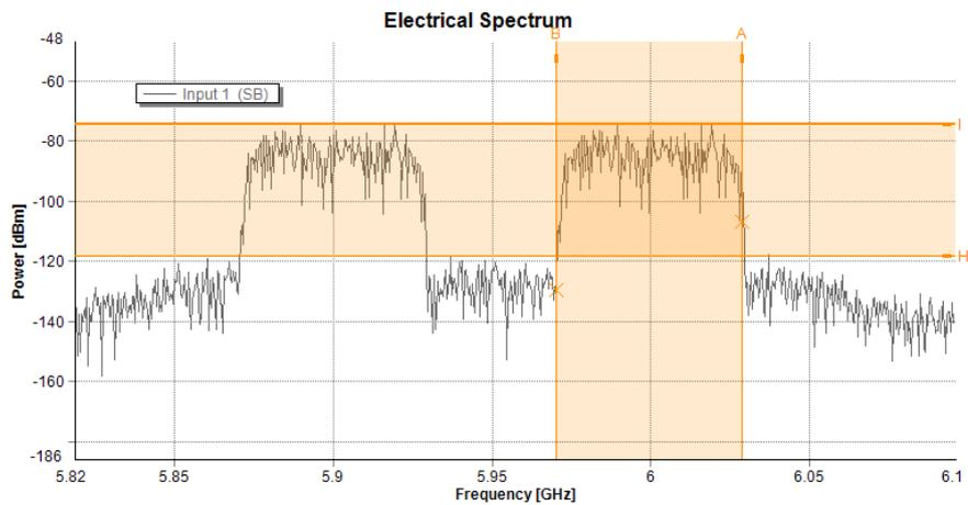
Figura 6.3: IM-IM: Espectro elétrico recebido no detetor de *uplink* para potência RF de entrada no *downlink* e *uplink* de -6 dBm; Nível de Potência RF à saída: -74 dBm ; Nível de Ruído: -114; SNR: 40 dB ; EVM: 0,8 %
