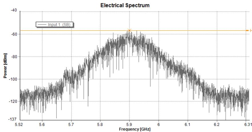
Figura 6.15: IM-IM: Componente fundamental do sinal RF de *uplink* recebida para potência RF de entrada no *downlink* de 16 dBm e -6 dBm de *uplink*; Nível de Potência RF à saída: ; Nível de Ruído: Indistinguível ; EVM: 91 %
