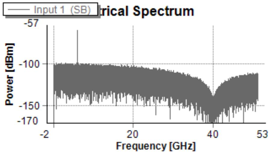
Figura 5.21: PM-BD: Espectro elétrico para ligação com nível de potência RF de entrada de -6 dBm
