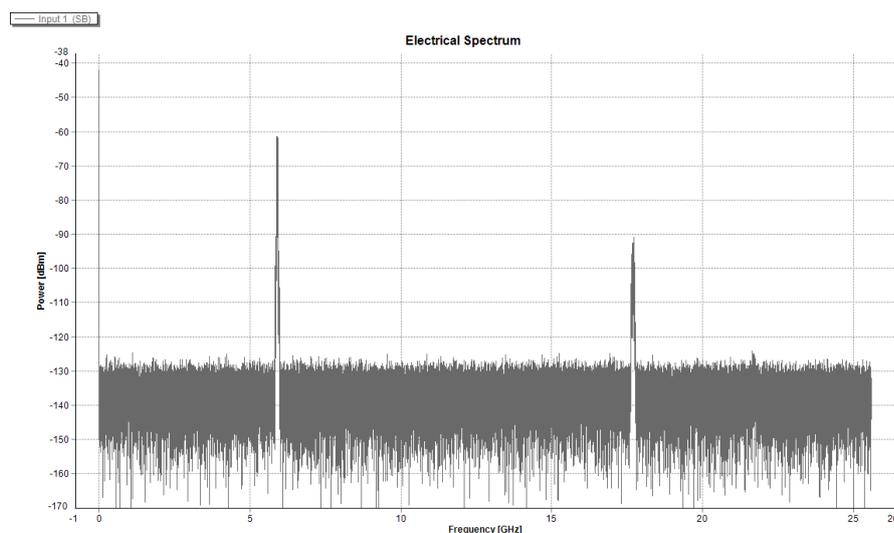
Figura 5.19: IM-DD: Espectro elétrico para ligação com nível de potência RF de entrada de 2 dBm
