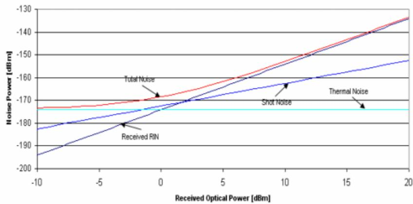
Figura 3.8: Potência ótica calculada vs. potência ótica recebida do foto-díodo, assumindo um valor de *RIN*= -155dB/Hz [6]
