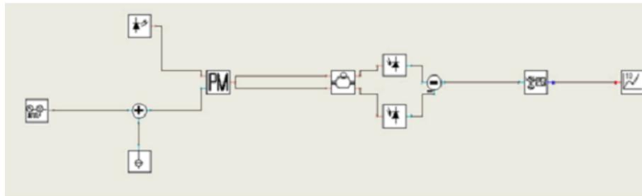
Figura 5.2: Esquema VPI com modulação em fase, interferômetro e detecção balanceada
