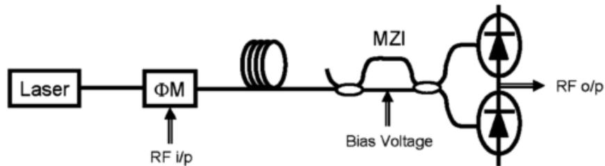
Figura 4.5: Sistema com modulação em fase, interferômetro e detecção balanceada [7]
