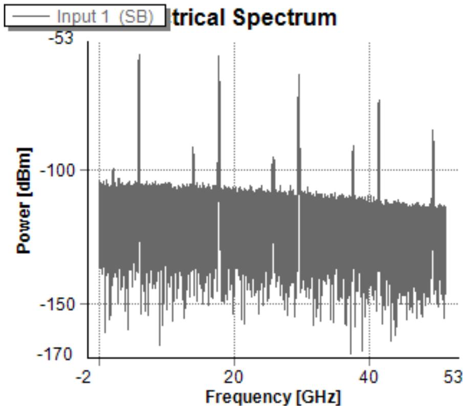
Figura 5.23: PM-BD: Espectro elétrico para ligação com nível de potência RF de entrada de 16 dBm
