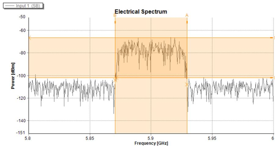
Figura 5.11: PM-BD: Espectro aproximado da componente fundamental com frequência central a 5.9 Ghz. Nível de potência RF: -12 dBm, Nível de potência recebida: -66 dBm, Nível de ruído: -100 dBm, SNR: 39 dB, EVM: 1,90 %
