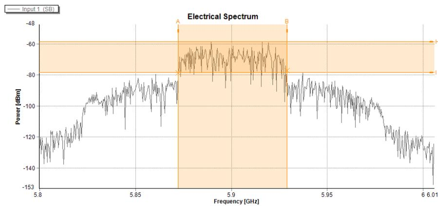
Figura 5.8: IM-DD: Espectro aproximado da componente fundamental com frequência central a 5.9 GHz. Nível de potência RF: 6 dBm, Nível de potência recebida: -58 dBm, Nível de ruído: -78 dBm, SNR: 20 dB EVM: 12,38 %
