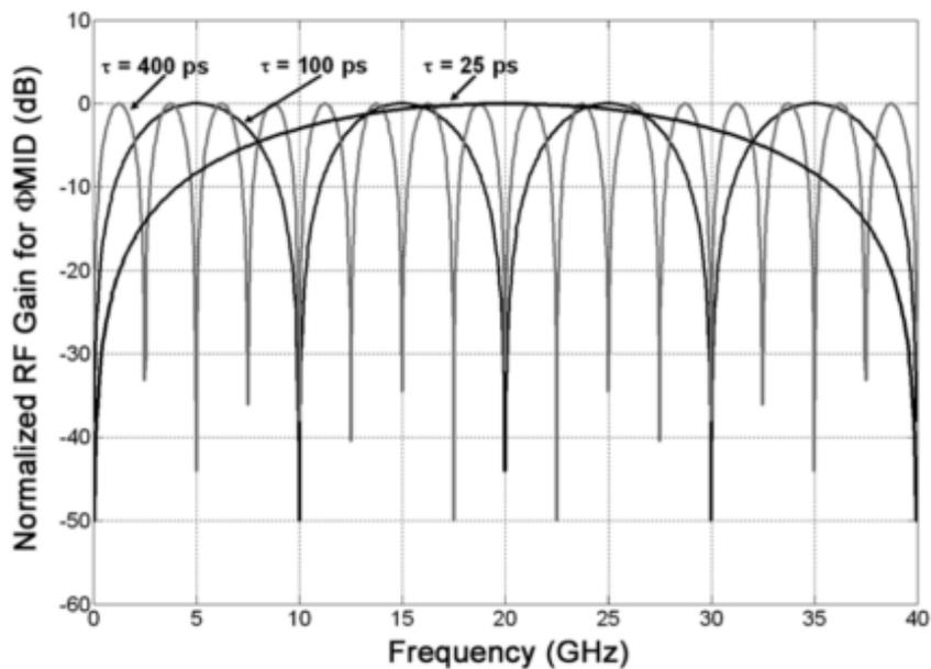
Figura 4.8: Característica do ganho normalizado para modulação em fase com detecção interferométrica para três valores diferentes de  $\tau$  [7]
