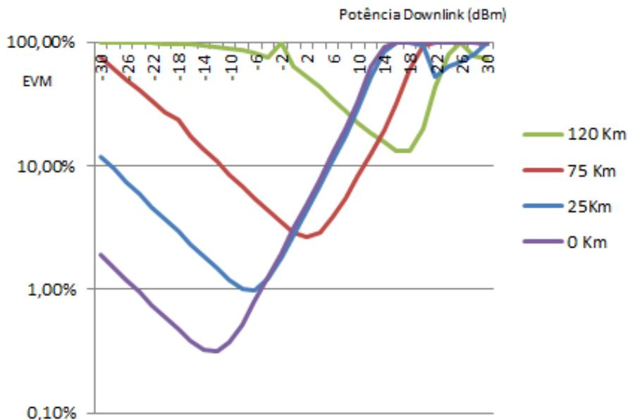
Figura 5.29: Evolução do EVM com a potência de entrada de *downlink*, para comprimentos de fibra de 0, 25, 75 e 120 Km
