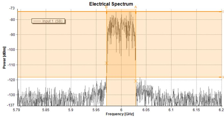
Figura 6.10: PM-IM: Componente fundamental do sinal RF de *uplink* recebida para potência RF de entrada *downlink* de 16 dBm e -6 dBm de *uplink*; Nível de Potência RF à saída: -74 dBm ;Nível de Ruído: -114 dBm; SNR: 40 dB; EVM: 0,8 %
