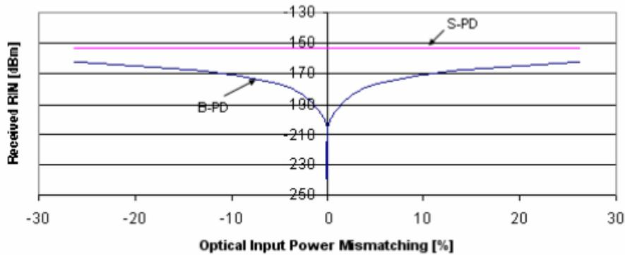
Figura 3.9: Efeito da diferença de potência entre os dois foto-díodos no cancelamento do ruído de RIN, assumindo o foto-detector com  $0.75A/W$ , RIN do DFB laser  $-155dB/Hz$ , e potência ótica de entrada de  $10dBm$  [6]
