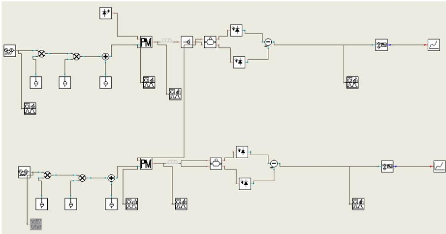
Figura 6.11: Configuração IM-IM standard no *VPIPhotronics*
