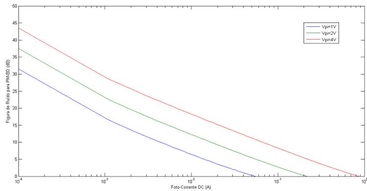
Figura 4.7: Figura de ruído da configuração IMDD em relação a foto-corrente para diferentes valores de  $V_{\pi}$  (1,2 e 4 V)
