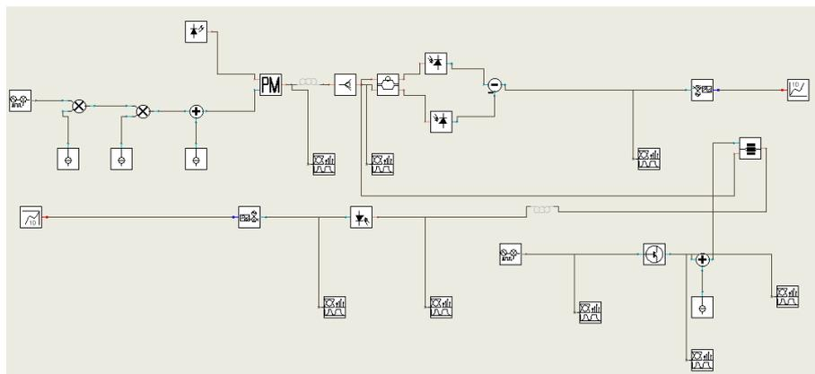
Figura 6.6: Configuração PM-IM standard no *VPIPhotonics*
